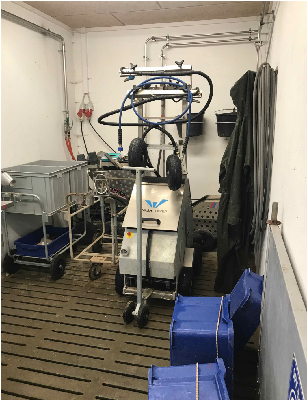
Figur 7. Robottvätt för tvätt av grisavdelningar från Washpower A/S. Foto RISE Jordbruk och trädgård.
